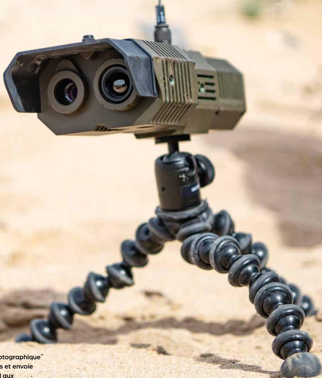
Ce "Capteur déposé photographique" détecte les mouvements et envoie les clichés en temps réel aux combattants.
