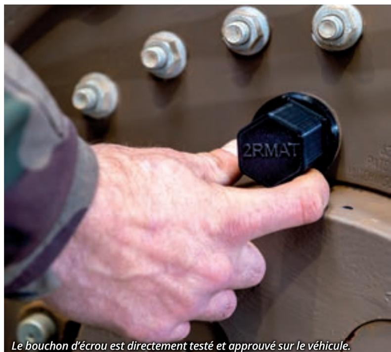
Le bouchon d'écrou est directement testé et approuvé sur le véhicule.
