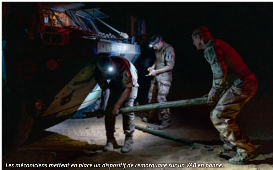
*Les mécaniciens mettent en place un dispositif de remorquage sur un VAB en panne.*
