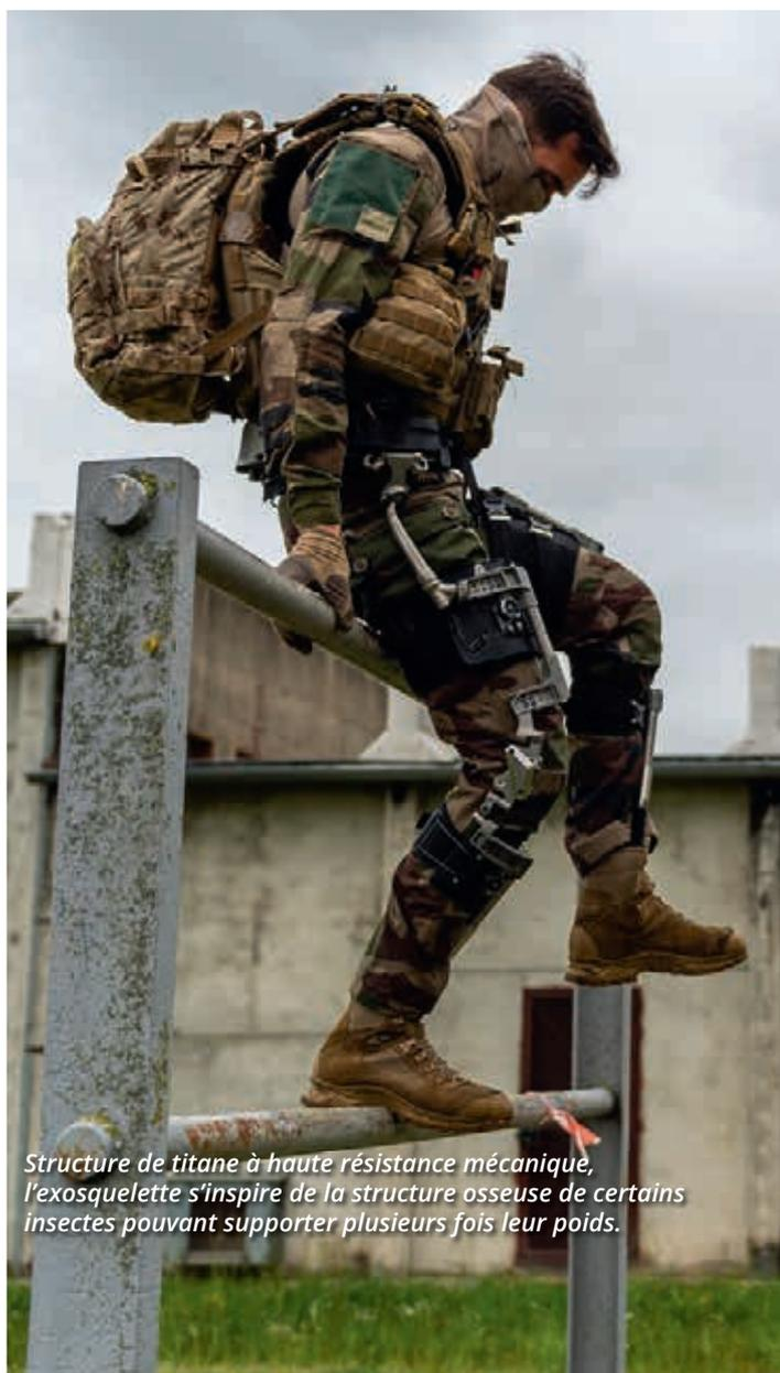
Structure de titane à haute résistance mécanique, l'exosquelette s'inspire de la structure osseuse de certains insectes pouvant supporter plusieurs fois leur poids.
