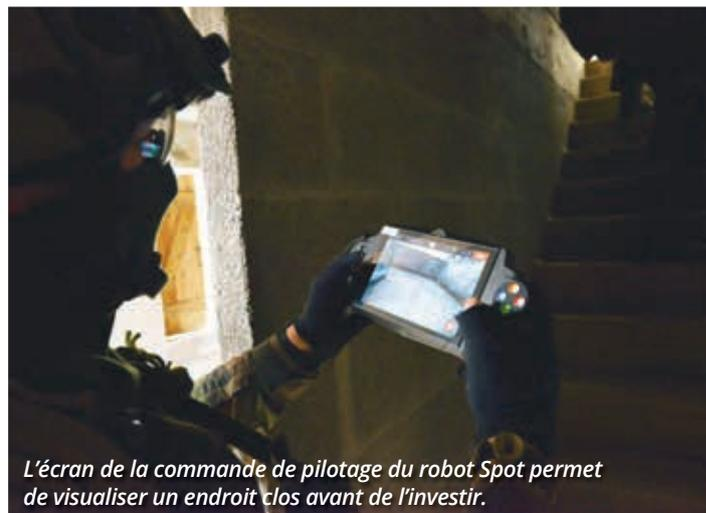
*L'écran de la commande de pilotage du robot Spot permet de visualiser un endroit clos avant de l'investir.*
