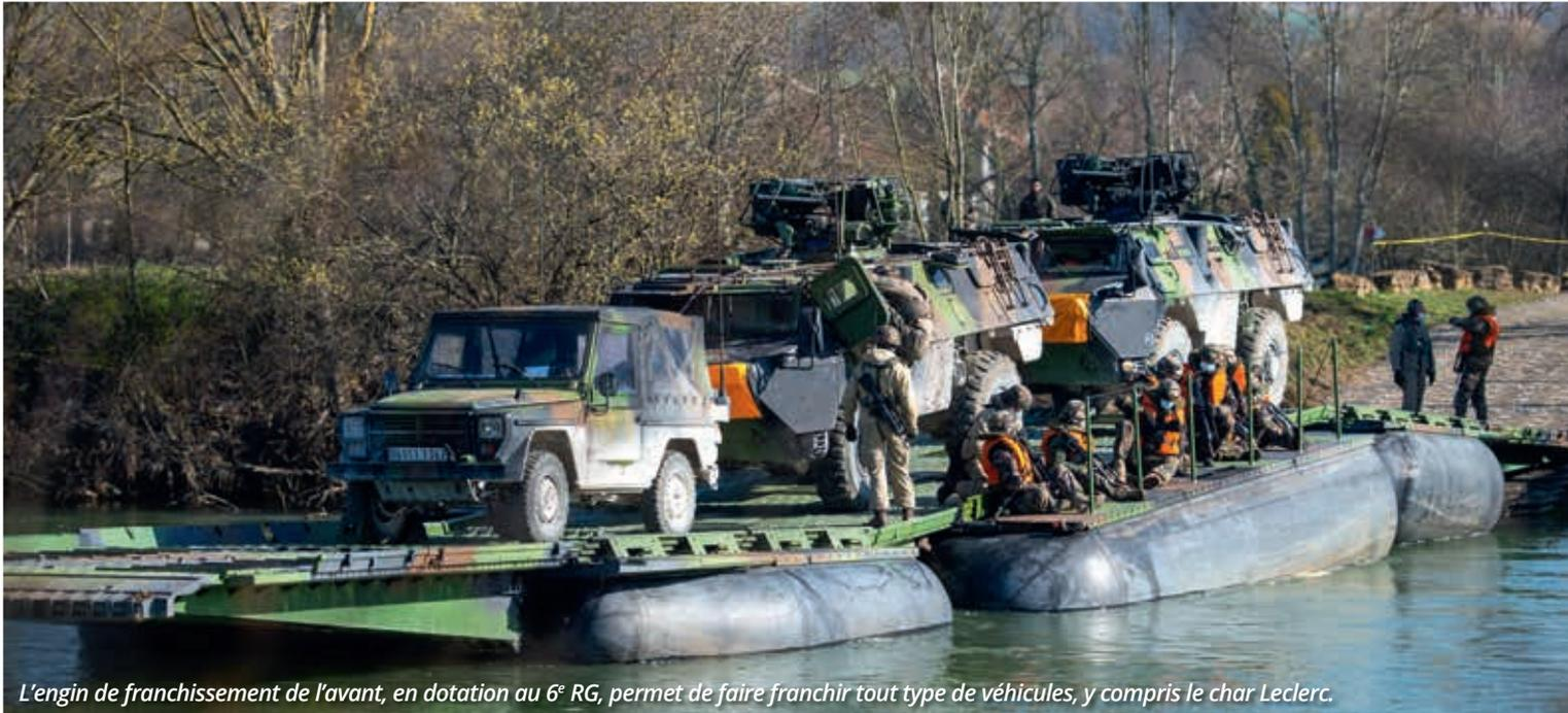
*L'engin de franchissement de l'avant, en dotation au 6<sup>e</sup> RG, permet de faire franchir tout type de véhicules, y compris le char Leclerc.*
